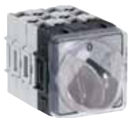
Commutatori voltmetrici 3 tensioni concatenate da retroquadro con mostrina grigia (schema cam 18) IP65
